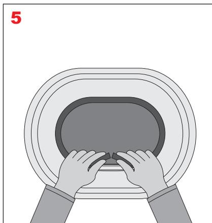
◀ Le profilé en caoutchouc est déjà à la bonne longueur. Pour finir, positionner les deux extrémités bout à bout et les installer en même temps.
