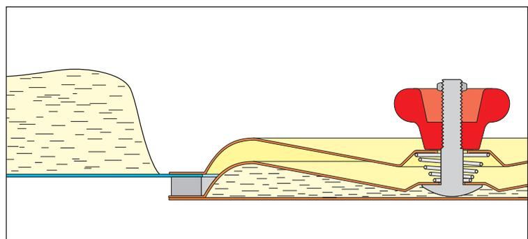
Toutes les trappes de visite indiquées ci-dessus résistent à des températures de fonctionnement allant de -70°C à +70°C. Pour des températures de fonctionnement plus élevées la trappe IRD-3PL est disponible en version HT avec joint en fibres de céramique (KF) et boutons-étoile en acier. Veuillez nous consulter.
